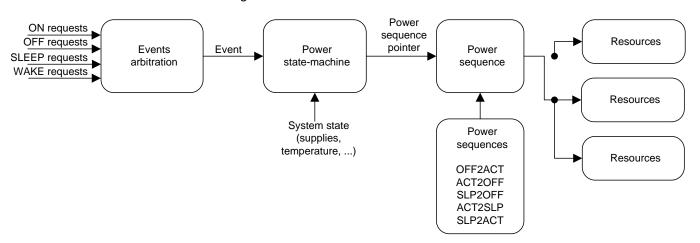
图 5-1. EPC Block Diagram
