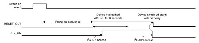
图 5-7. DEV\_ON Mode Timing Diagram
