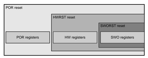
图 5-9. Reset Levels versus Registers
