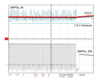
图 6-4. Waveform of SMPSx\_IN Transients
