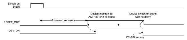
图 5-6. AUTODEVON Mode Timing Diagram
