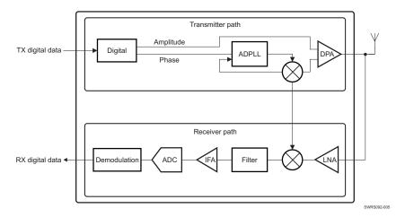
Figure 6-9. DRP Block Diagram
