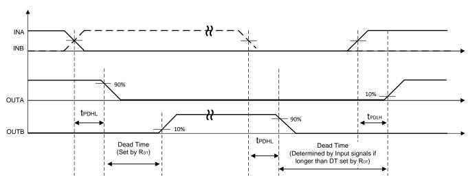
图 30. Dead Time Switching Parameters
