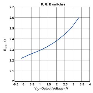
Figure 4. R<sub>ON</sub> vs V<sub>O</sub>
