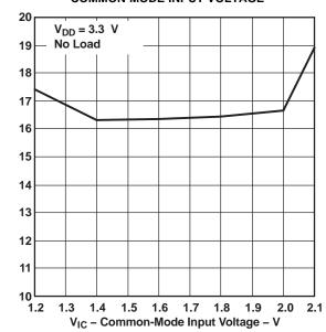
V<sub>IO</sub> - Input Offset Voltage - mV
