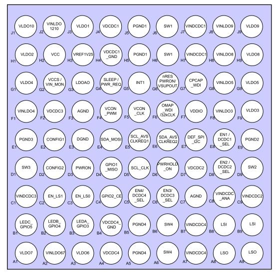
Figure 4-1. 81-Pin YFF DSBGA (Bottom View)
