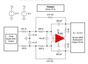
增益为 10V/V 且具有 50kHz 二阶 MFB 滤波器的 PCM 音频 DAC 输出
