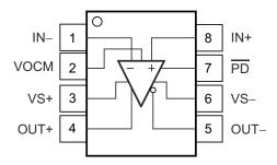
图 6-1. DGK Package 8-Pin VSSOP Top View
