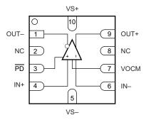
图 6-2. RUN Package 10-Pin WQFN Top View
