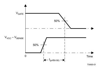
Figure 30.  $t_{prf50-50}$  Timing Definition
