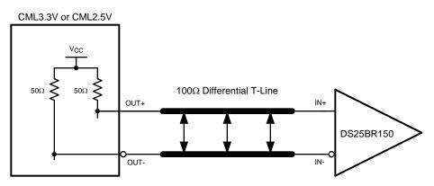
Figure 7. Typical CML Driver DC-Coupled Interface to DS25BR150 Input
