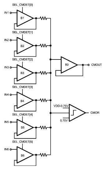
Figure 21. Common-Mode Detector Circuit
