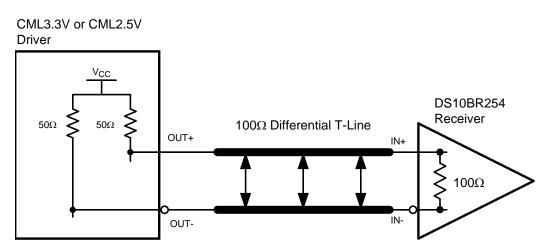
Figure 3. Typical CML Driver DC-Coupled Interface to an DS10BR254 Input
