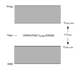
Figure 29. V<sub>COM</sub> Voltage Levels
