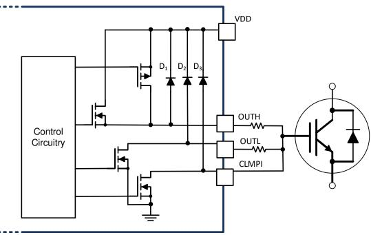
图 8-3. Short Circuit Clamping
