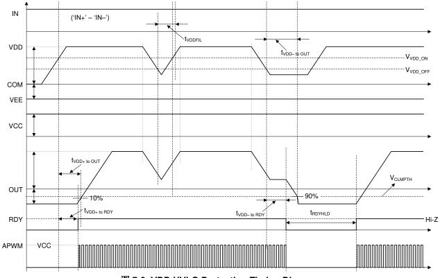
图 7-9. VDD UVLO Protection Timing Diagram
