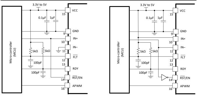
图 9-4. Automatic Reset Control
