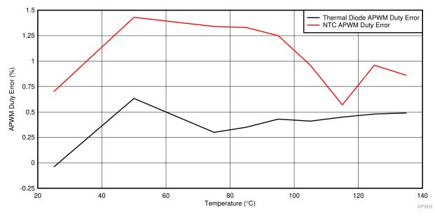
图 9-10. APWM Duty Error Without Calibration
