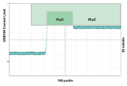
图 20. USB-IF Inrush Current Test
