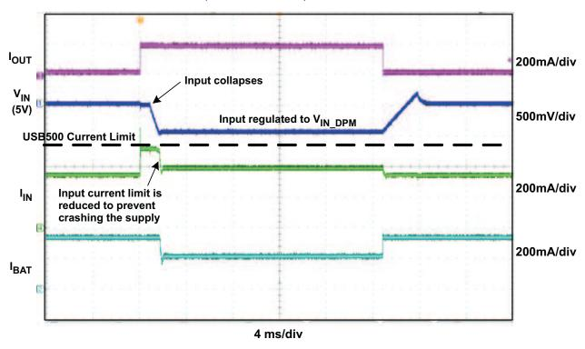
图 21. V<sub>IN</sub>-DPM Waveform
