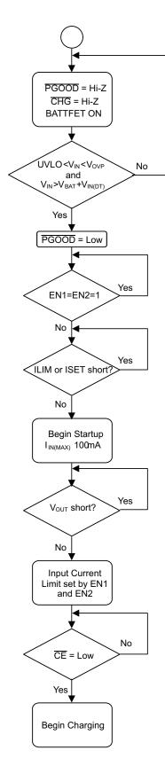
图 19. Startup Flow Diagram
