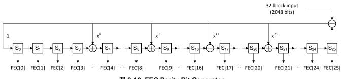
图 8-10. FEC Parity Bit Generator
