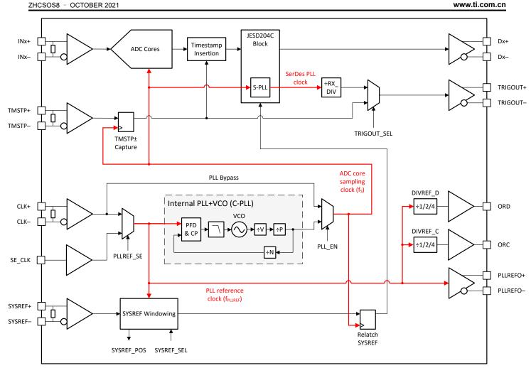
图 8-5. Clocking Subsystem
