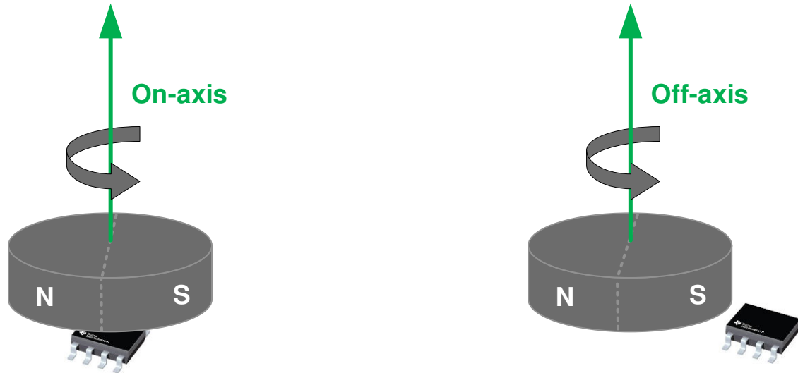
图 8-5. 同轴角度测量与离轴角度测量
