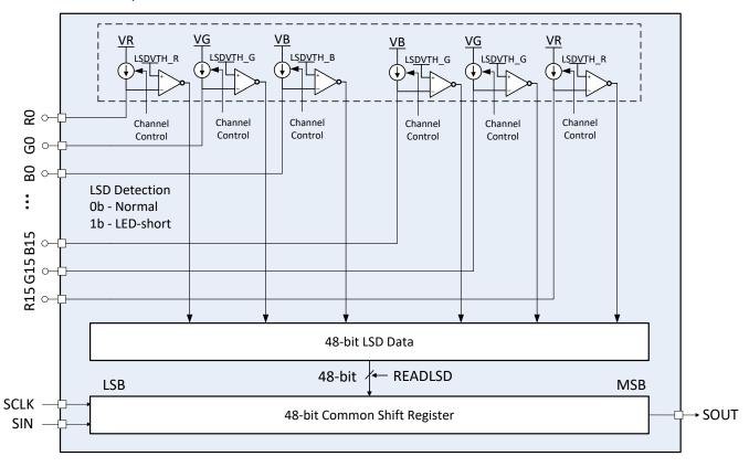
图 8-9. LED Short Detection Circuit
