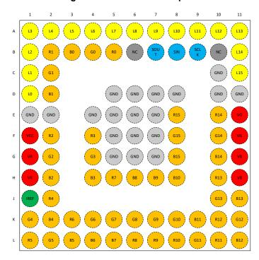
图 6-2. LP5890 ZXL Package 96-Pin BGA Top View
