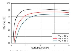
典型效率 ( V<sub>OUT</sub> = 5V, F<sub>SW</sub> = 1MHz )
