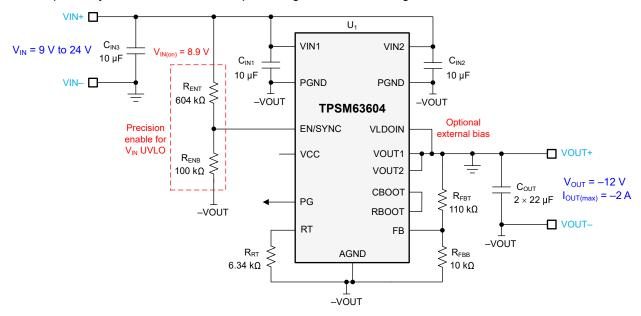
图 9-10. Circuit Schematic
