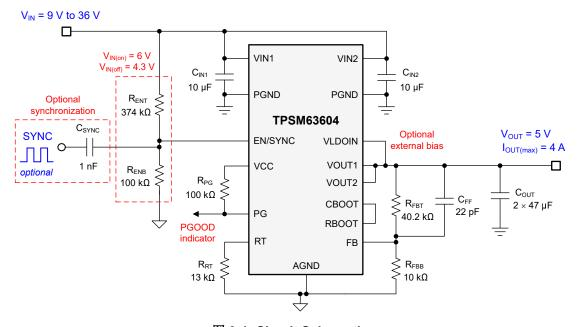
图 9-1. Circuit Schematic
