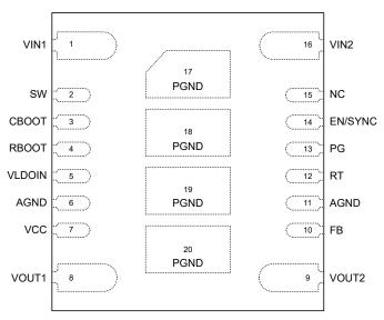
图 6-1. 20-Pin QFN RDL Package (Top View)
