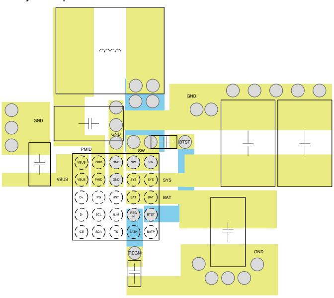
图 11-2. PCB Layout Example
