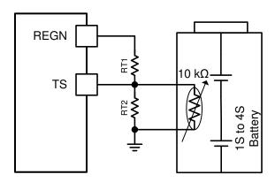
图 8-10. TS Resistor Network
