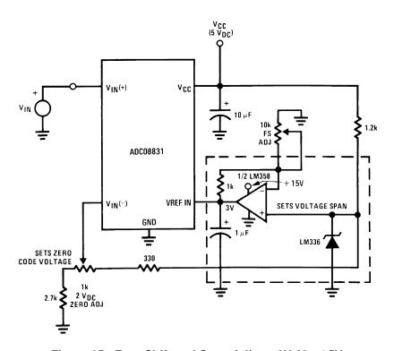
Figure 25. Zero-Shift and Span Adjust: 2V≤V<sub>IN</sub> ≤ 5V
