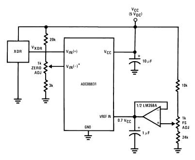
$^*V_{IN}(-) = 0.15 \ V_{CC}$ 15% of  $V_{CC} \le V_{XDR} \le 85\%$  of  $V_{CC}$
