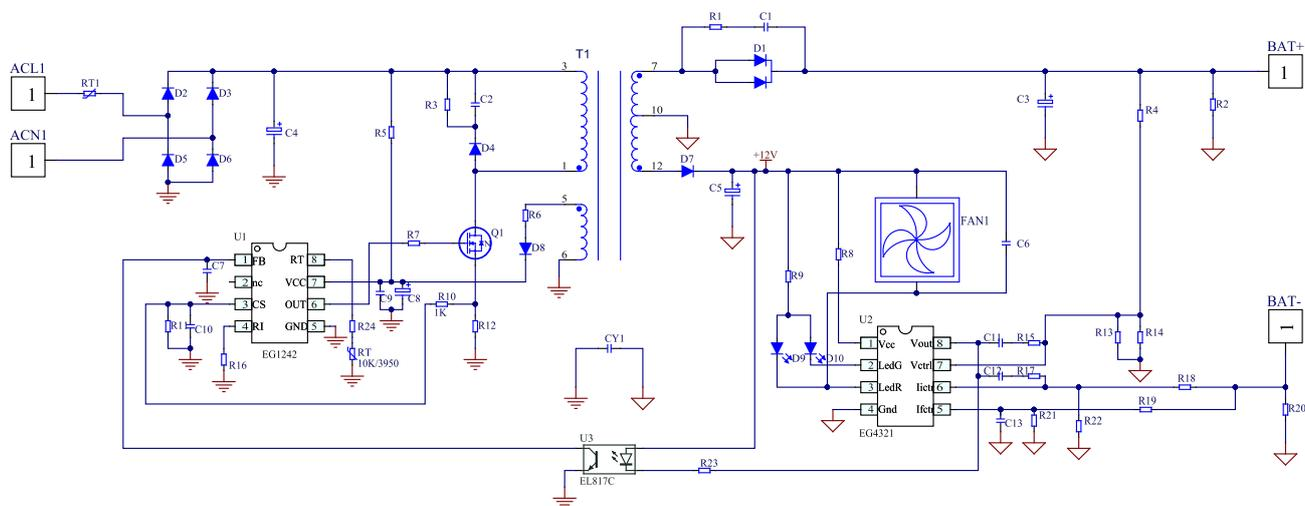
图 6-1. EG1242+EG4321 恒压恒流锂电池充电器应用图
