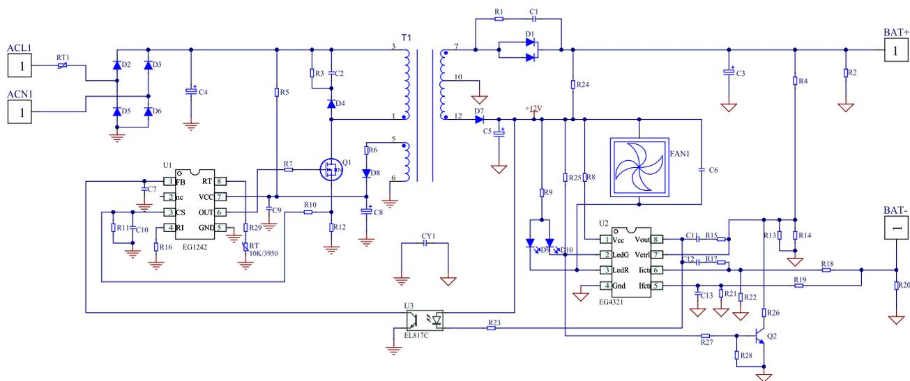
图 6-2. EG1242+EG4321 三段式铅酸电池充电器应用图
