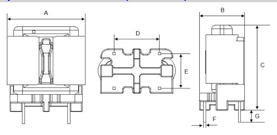
PCB aperture ≥ Ф 1.4mm
