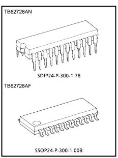
Weight SDIP24-P-300-1.78: 1.22 g (typ.) SSOP24-P-300-1.00B: 0.32 g (typ.)
