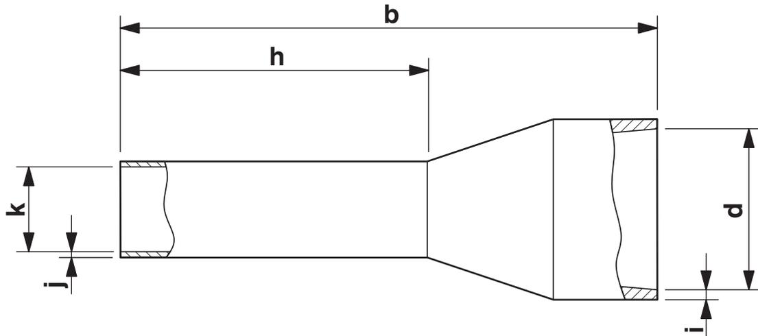
长度(b)、套管长度(h)、绝缘套管内部尺寸(d)、套管直径(k)、绝缘套管厚度(i)、套管壁厚(j)
