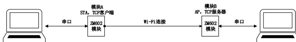
图 3-1 两个模块做 Wi-Fi 串口透传
