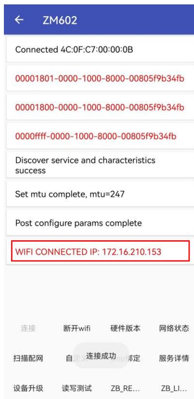
图 5-7 成功连接目标热点
