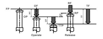
操作力 回复力 全行程力 自由位置 动作位置 OF: Operating Force RF: Release Force TF: Total travel Force FP: Free Position OP: Operating Position 全行程位置 TTP: Total Travel Position RP: Release Position 释放位置 行程 超行程 PT: Pre Travel OT: Over travel 差动行程
