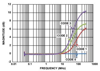
FIGURE 3. FREQUENCY RESPONSE vs 100MHz BITS 1:0
