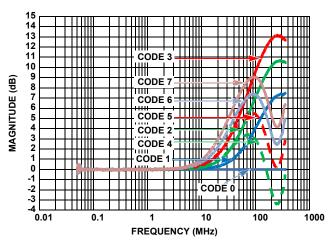
FIGURE 4. FREQUENCY RESPONSE vs 100MHz BITS 4:2
