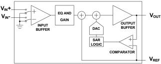
FIGURE 12. OFFSET CALIBRATION (ONE CHANNEL SHOWN)
