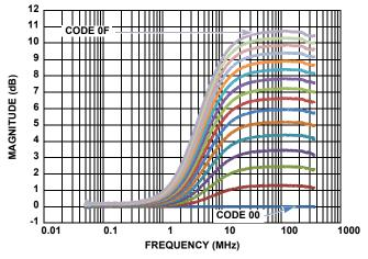
FIGURE 7. FREQUENCY RESPONSE vs 6MHz BITS 3:0
