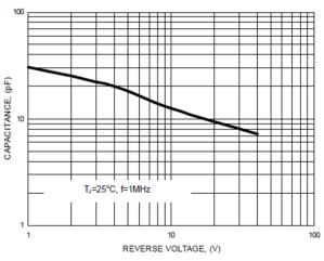
FIG.4- TYPICAL TOTAL CAPACITANCE
