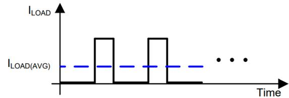
由于芯片的瞬态电流很小，一般可以忽略，故假设输入电流等于输出电流，则芯片的功耗 PD 可计算为输入电压和输出电压的压差乘以电流，即得公式  $PD = (VIN - VOUT) \times I_{IN}$ ，由于输入电流也等于负载电流，因此可得公式  $PD = (VIN - VOUT) \times I_{LOAD}$  但由于瞬态负载电流的存在，功耗 PD 应为  $PD = (VIN - VOUT) \times I_{LOAD(AVG)}$
