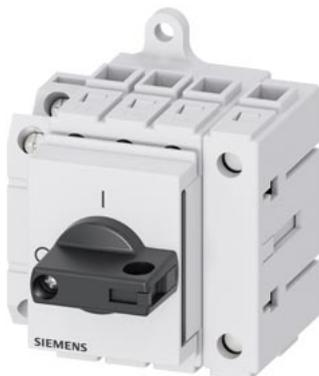
负载隔离开关 3LD3, Iu 63 A 3 极主开关 + N 额定运行功率 400 V 23 A AC 时 22.0 kW 配线盘安装件 基础开关, 带 黑色旋钮操作机构 带辅助开关 1NC+1NO
