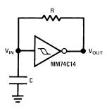
$$t_1 \approx RC \ln \frac{V_{T+}}{V_{T-}}$$
