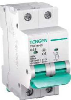
TGB1N-63 小型断路器（以下简称断路器）主要适用于交流 50/60Hz，额定电压 230V/400V，额定电流至 63A 的家用及类似场所的电力线路设施和电气设备进行过载和短路保护之用，亦可用于不频繁地通断操作。尤其适用于工业和商业的照明配电系统。
