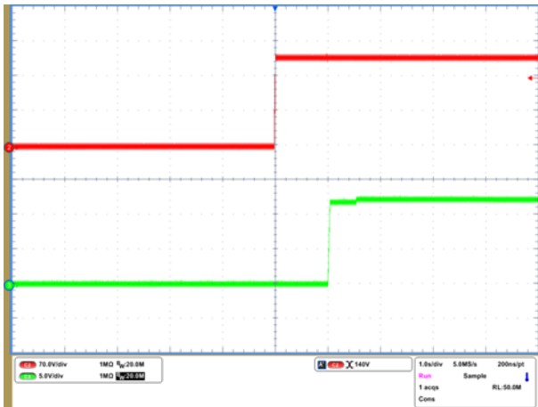
开机 ( V_{in}=240V\ DC, V_{out}=12V_{sb} )
