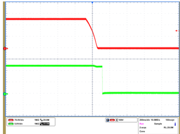
关机 ( V_{in}=240V\ DC, V_{out}=12V_{sb} )
