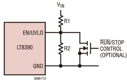
图 12. V<sub>IN</sub> 欠压闭锁 (UVLO)
