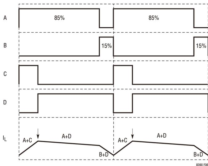
图 4. 降压区域中的峰值-降压 ( $V_{IN} \gg V_{OUT}$ )
