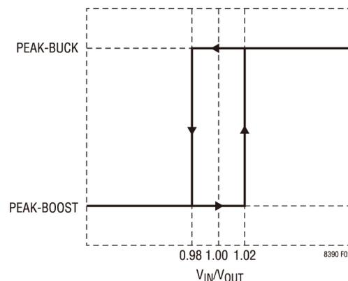
图 2. 电流模式与  $V_{IN}/V_{OUT}$  之比的关系
