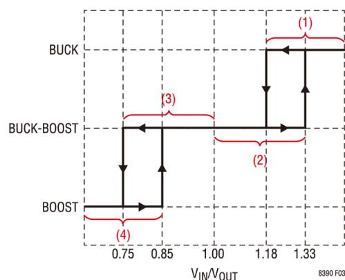
图 3. 工作区域与  $V_{IN}/V_{OUT}$  之比的关系
