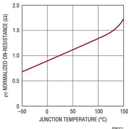
图 11. 归一化  $R_{DS(ON)}$  与温度的关系
