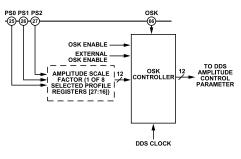
Figure 36. OSK Block Diagram
