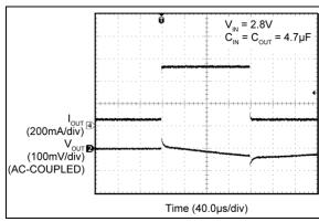
**FIGURE 2-17:** Load Transient.
