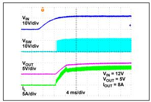
FIGURE 2-45: V<sub>IN</sub> Soft Turn-On.
