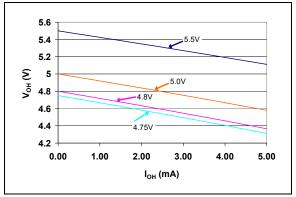
**FIGURE 2-22:**  $V_{\rm OH}$  vs.  $I_{\rm OH}$  (TC1270AL, TC1270ANL, TC1271AL - 4.50V min./4.63V typ./4.75V max.) @ +25°C).
