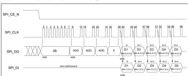
FIGURE 7-2: SPI DUAL HI-SPEED READ SEQUENCE
