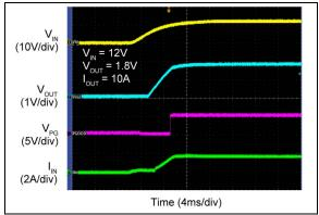
FIGURE 2-22: V<sub>IN</sub> Soft Turn-On.
