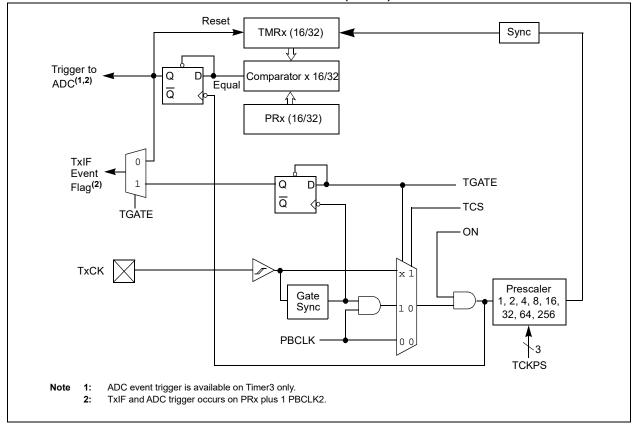
FIGURE 14-2: TIMER2/3, TIMER4/5 BLOCK DIAGRAM (32-BIT)
