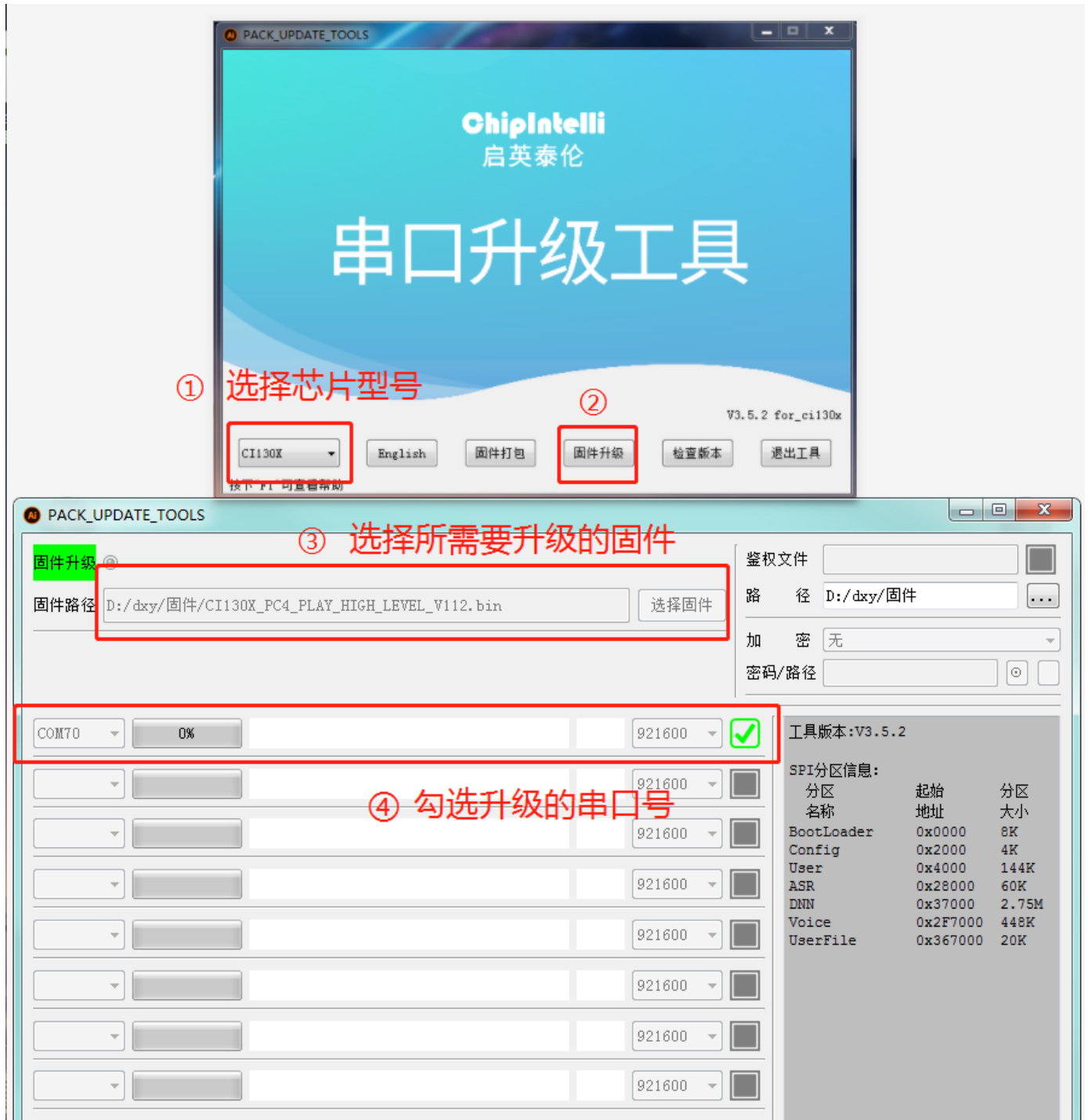
图13 固件烧录工具示意图
