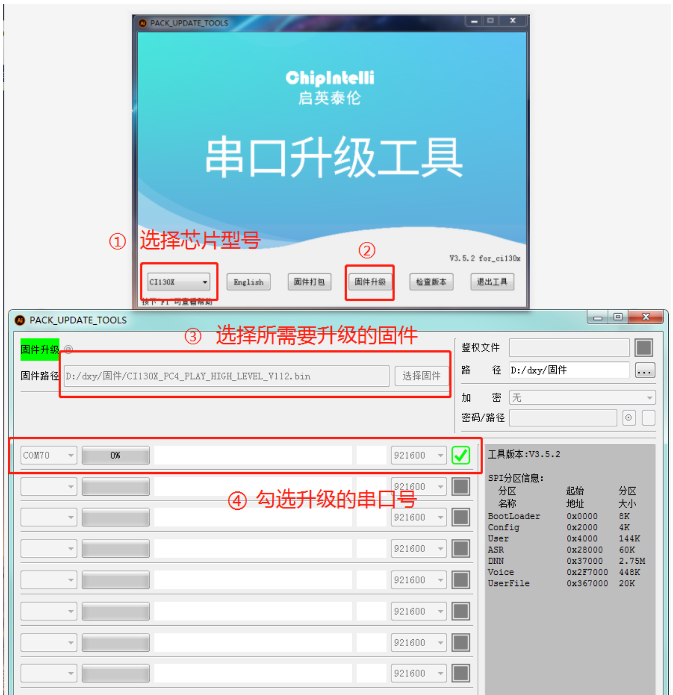
图14 固件烧录工具示意图
