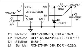
FIGURE 4-2: 8V<sub>IN</sub> - 24V<sub>IN</sub> to 5V/0.5A Buck Converter Through Hole.
