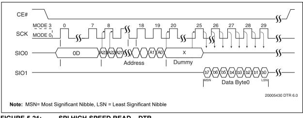
FIGURE 5-21: SPI HIGH-SPEED READ – DTR
