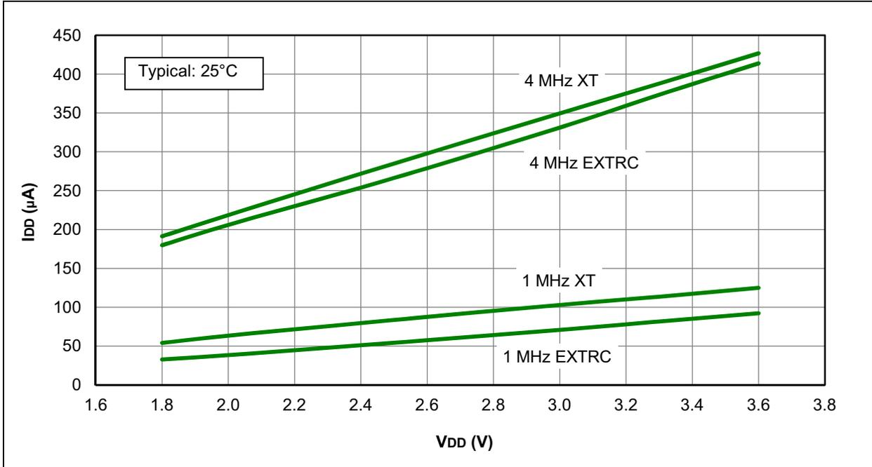
**FIGURE 31-4: I<sub>DD</sub> MAXIMUM, XT AND EXTRC OSCILLATOR, PIC16LF1938/9 ONLY**
