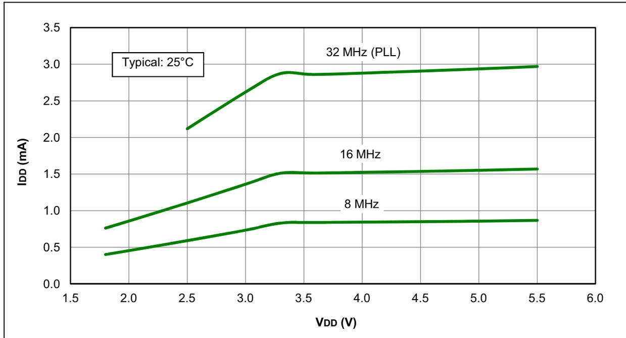
**FIGURE 31-18: I<sub>DD</sub> MAXIMUM, EXTERNAL CLOCK (ECH), HIGH-POWER MODE, PIC16F1938/9 ONLY**
