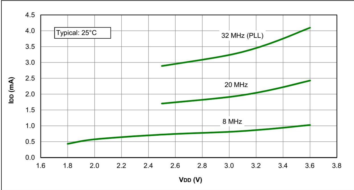
**FIGURE 31-28: I<sub>DD</sub> MAXIMUM, HS OSCILLATOR, PIC16LF1938/9 ONLY**
