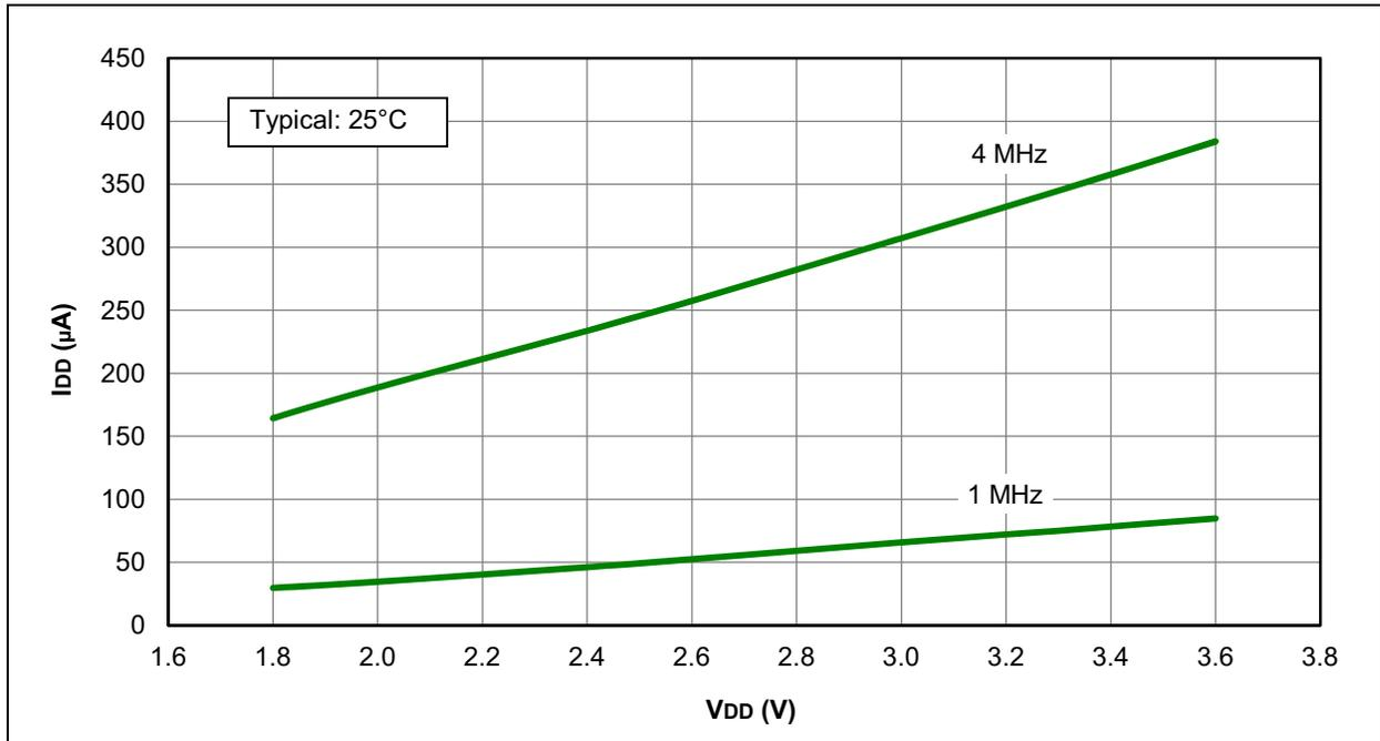
**FIGURE 31-12: I<sub>DD</sub> MAXIMUM, EXTERNAL CLOCK (ECM), MEDIUM-POWER MODE, PIC16LF1938/9 ONLY**
