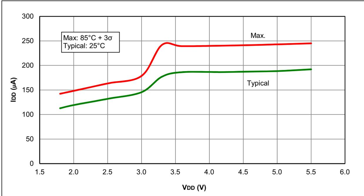
FIGURE 31-23: I<sub>DD</sub> TYPICAL, HFINTOSC, PIC16LF1938/9 ONLY
