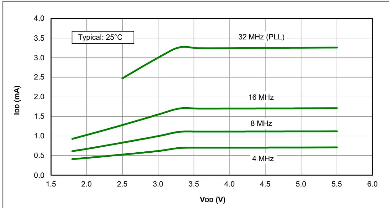
FIGURE 31-26: I<sub>DD</sub> MAXIMUM, HFINTOSC, PIC16F1938/9 ONLY
