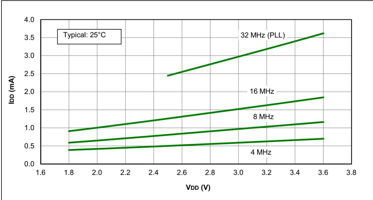
FIGURE 31-24: I<sub>DD</sub> MAXIMUM, HFINTOSC, PIC16LF1938/9 ONLY
