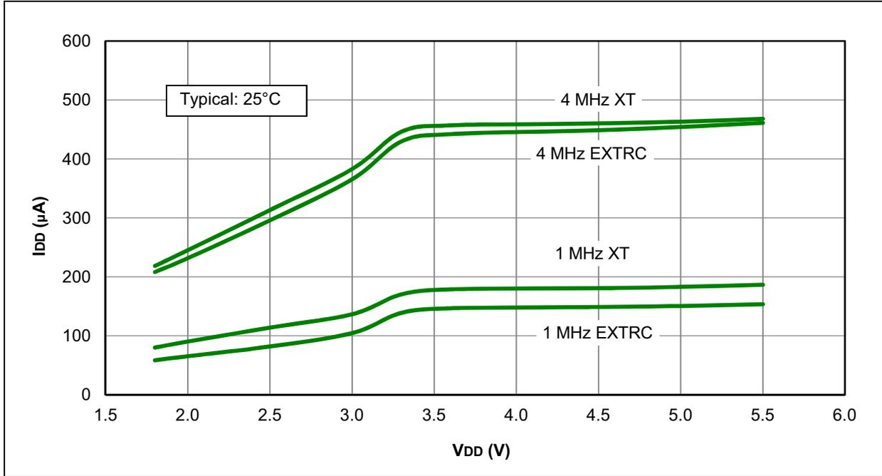
FIGURE 31-6: I<sub>DD</sub> MAXIMUM, XT AND EXTRC OSCILLATOR, PIC16F1938/9 ONLY
