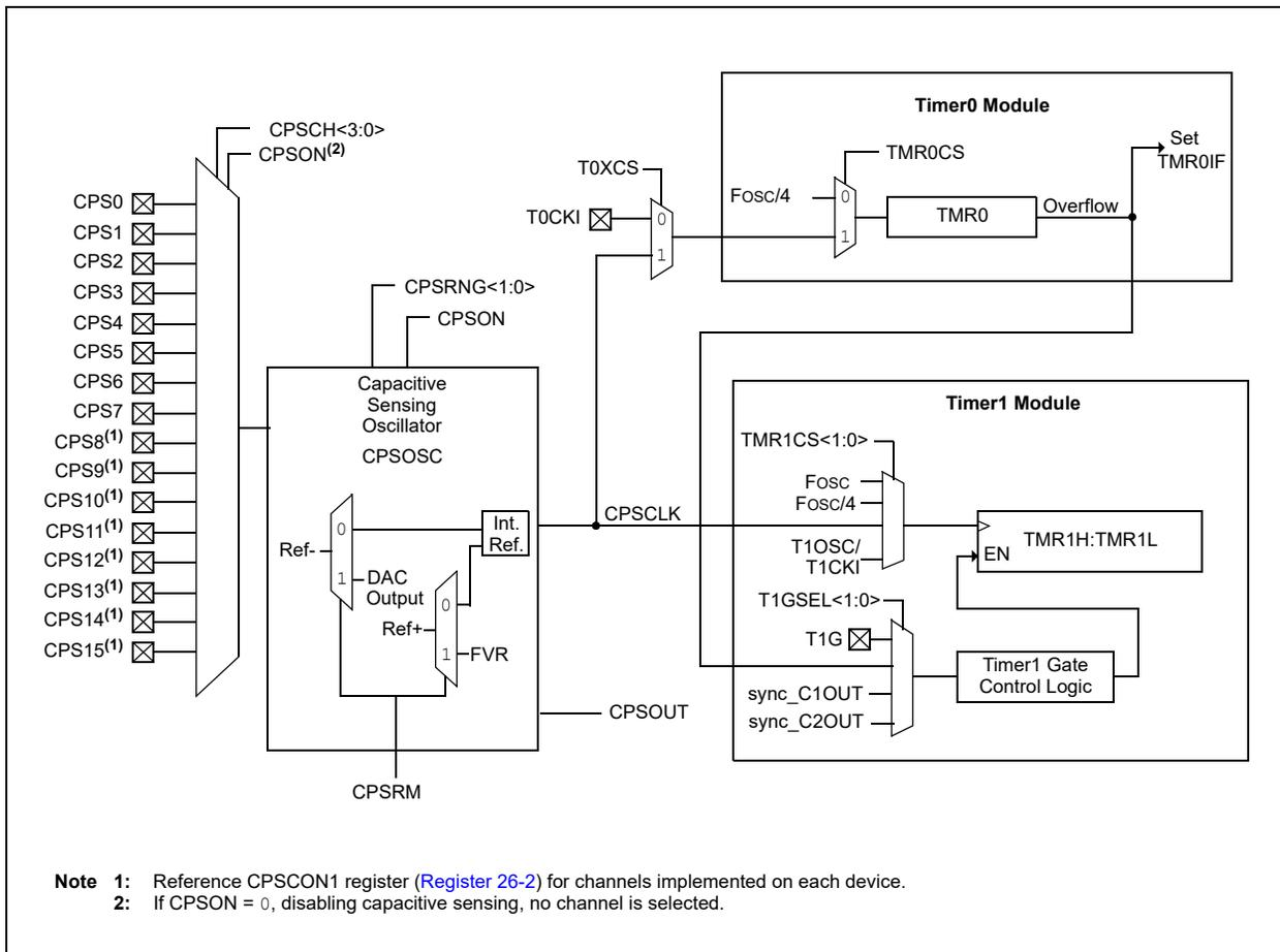
**FIGURE 26-2: CAPACITIVE SENSING OSCILLATOR BLOCK DIAGRAM**
