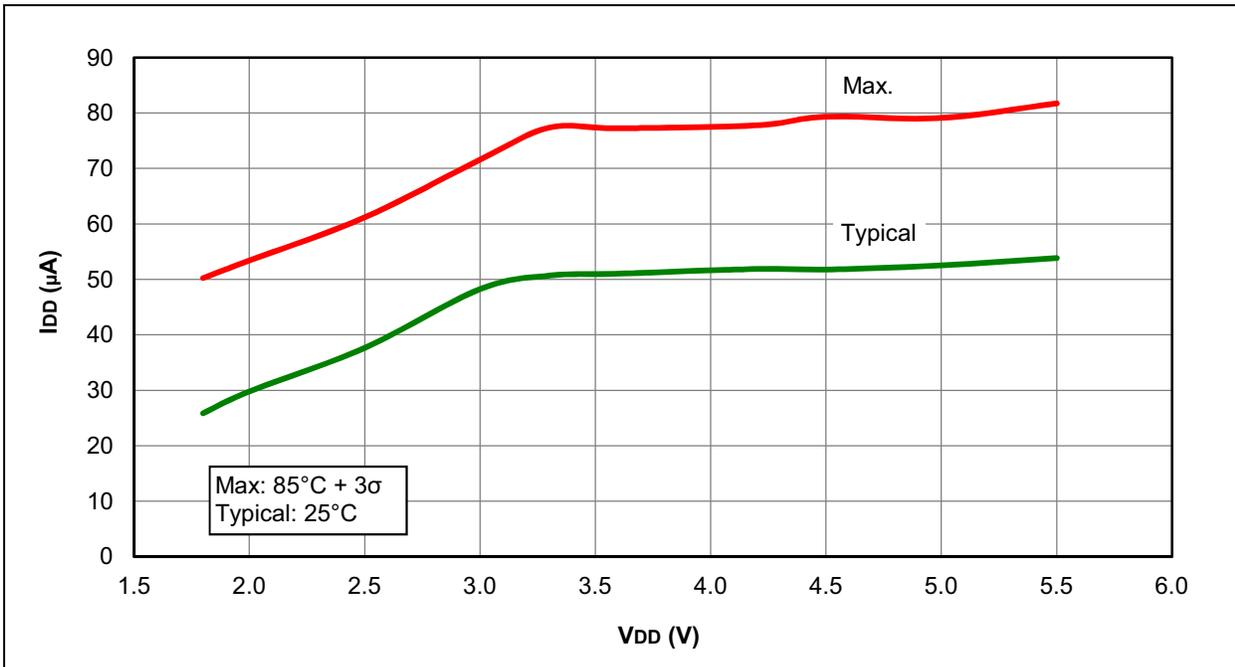
**FIGURE 31-11: I<sub>DD</sub> TYPICAL, EXTERNAL CLOCK (ECM), MEDIUM-POWER MODE, PIC16LF1938/9 ONLY**
