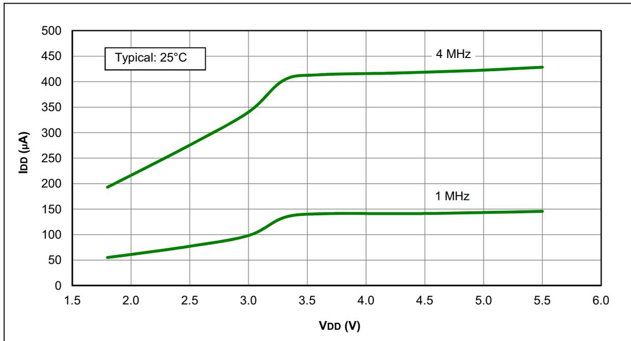
**FIGURE 31-14: I<sub>DD</sub> MAXIMUM, EXTERNAL CLOCK (ECM), MEDIUM-POWER MODE, PIC16F1938/9 ONLY**
