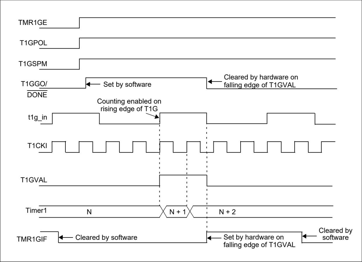
**FIGURE 21-6: TIMER1 GATE SINGLE-PULSE AND TOGGLE COMBINED MODE**
