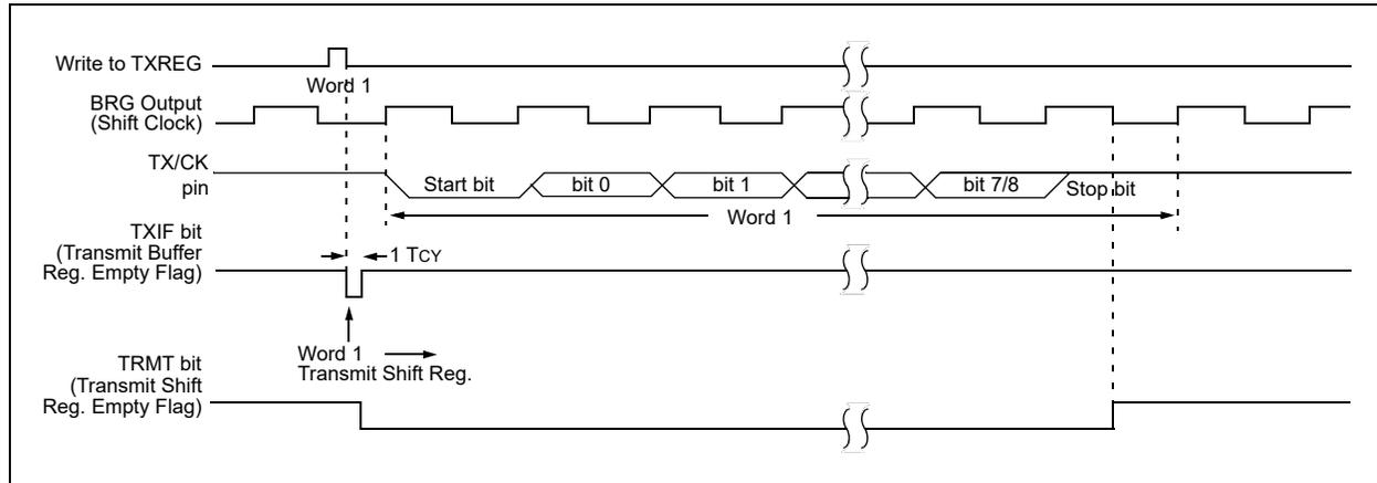
**FIGURE 25-4: ASYNCHRONOUS TRANSMISSION (BACK-TO-BACK)**
