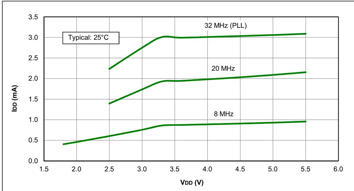
FIGURE 31-30: I<sub>DD</sub> MAXIMUM, HS OSCILLATOR, PIC16F1938/9 ONLY
