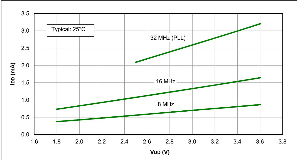
**FIGURE 31-16: I<sub>DD</sub> MAXIMUM, EXTERNAL CLOCK (ECH), HIGH-POWER MODE, PIC16LF1938/9 ONLY**
