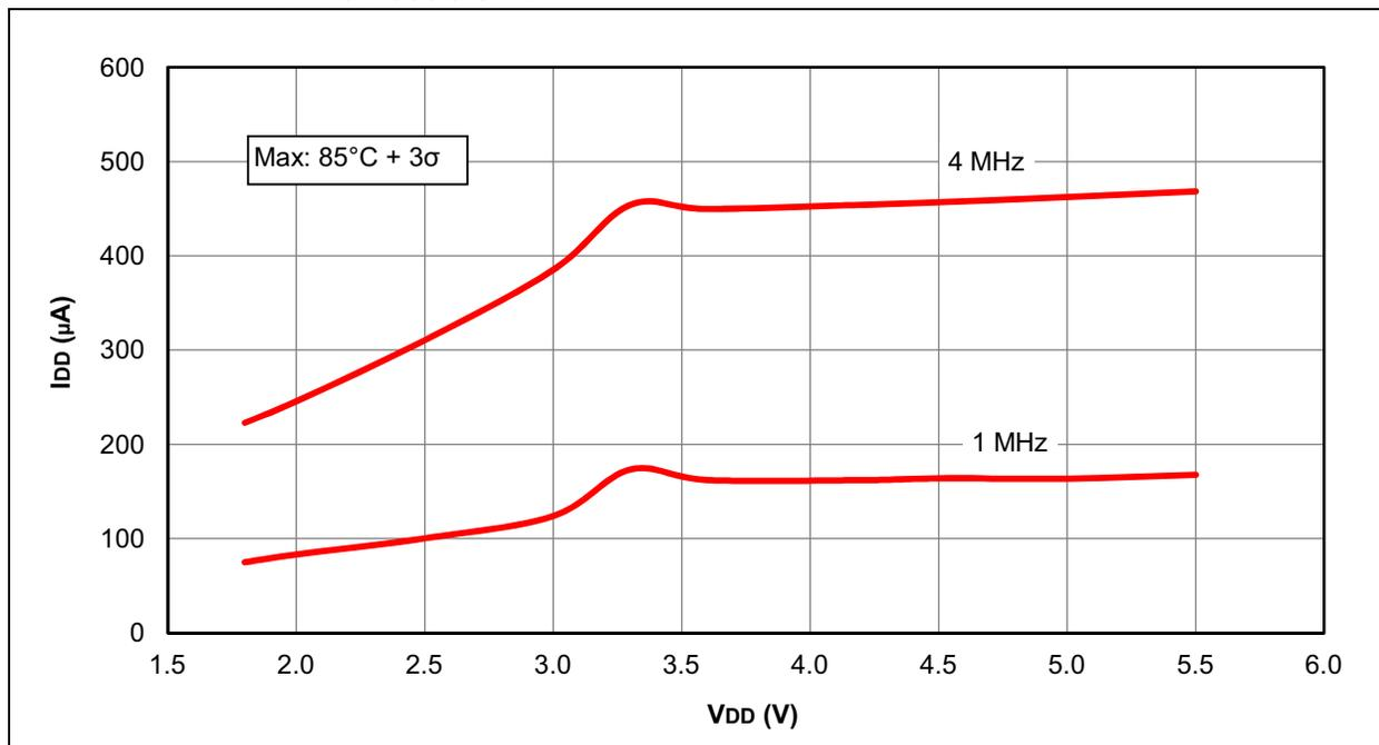
**FIGURE 31-15: I<sub>DD</sub> TYPICAL, EXTERNAL CLOCK (ECH), HIGH-POWER MODE, PIC16LF1938/9 ONLY**
