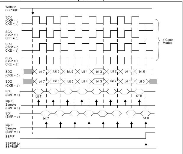
FIGURE 24-6: SPI MODE WAVEFORM (HOST MODE)
