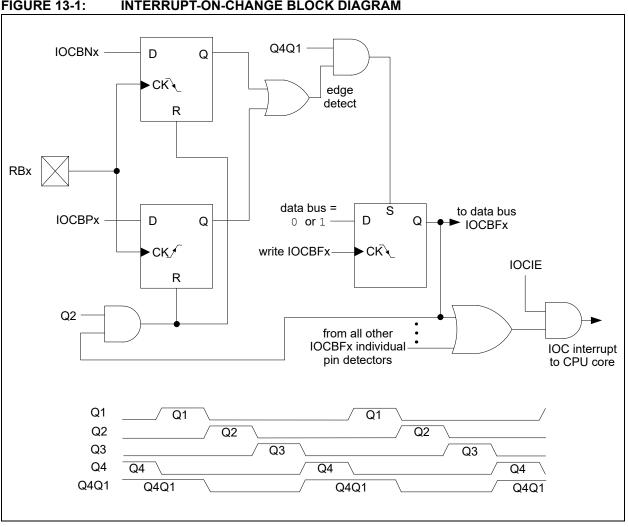
FIGURE 13-1: INTERRUPT-ON-CHANGE BLOCK DIAGRAM
