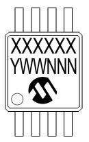
14-Lead SOIC (MCP6479)
