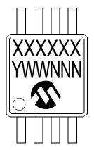
14-Lead SOIC (MCP6009)
