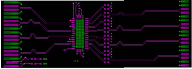
Figure 11-1. DS320PR421 layout example
